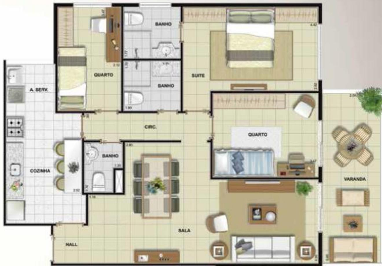
AS COTAS SÃO MEDIDAS DE EIXO A EIXO DE PAREDES.
