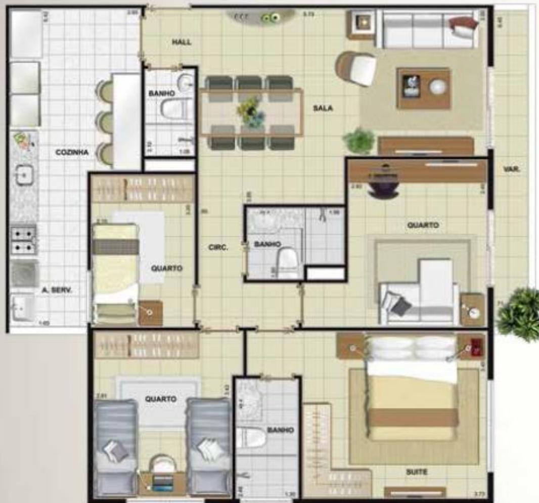
AS COTAS SÃO MEDIDAS DE EIXO A EIXO DE PAREDES.
