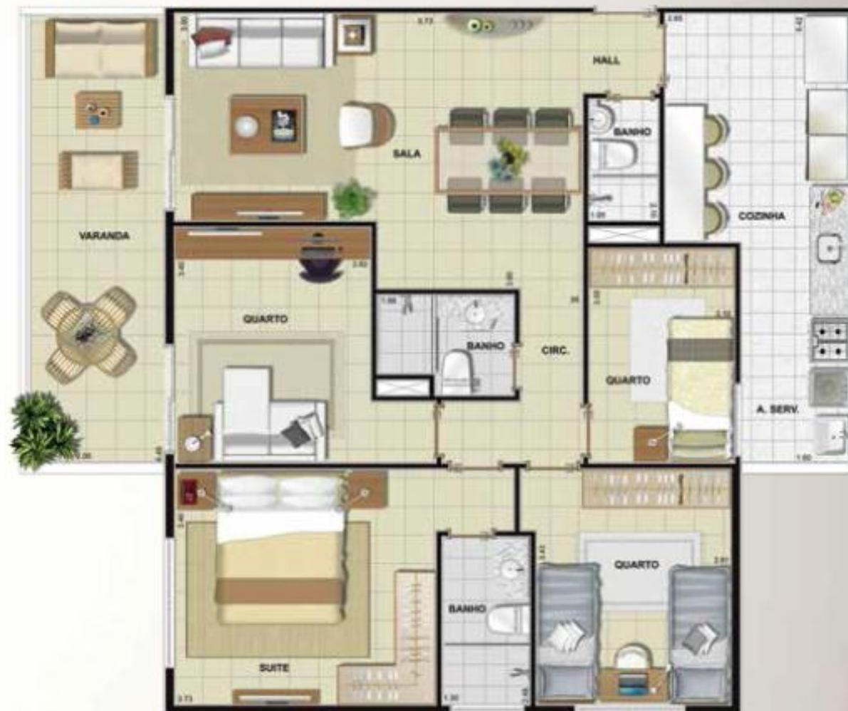
AS COTAS SÃO MEDIDAS DE EIXO A EIXO DE PAREDES.
