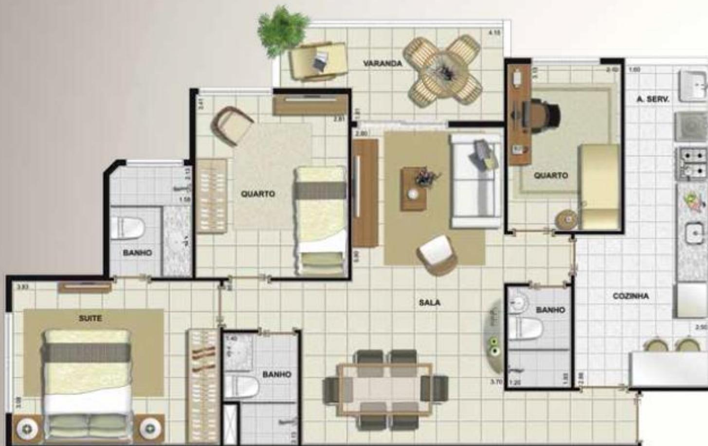
AS COTAS SÃO MEDIDAS DE EIXO A EIXO DE PAREDES.
