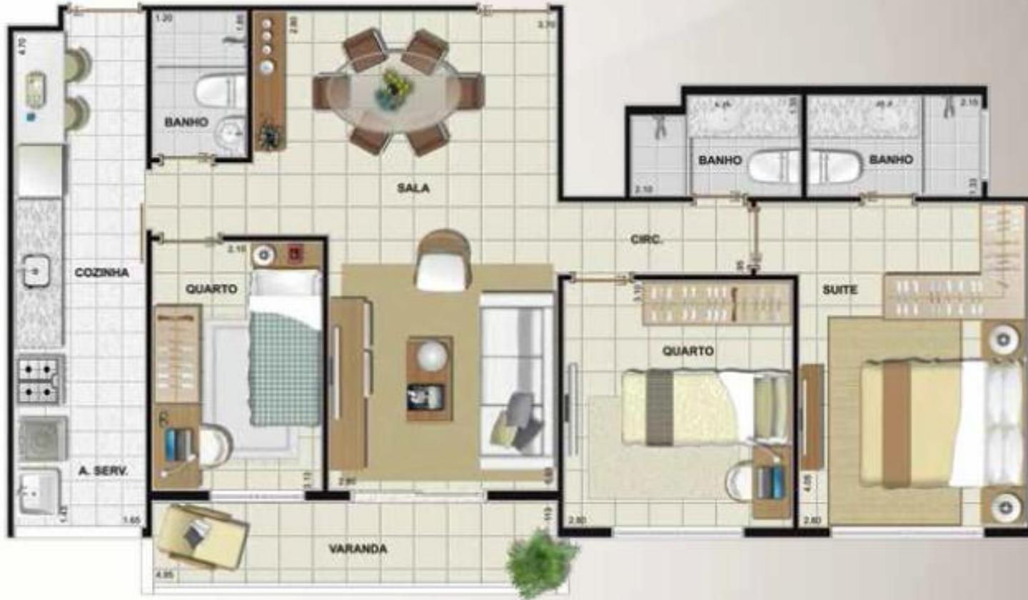
AS COTAS SÃO MEDIDAS DE EIXO A EIXO DE PAREDES.
